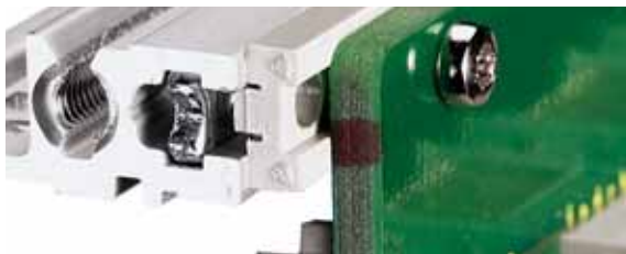
Modulschiene hinten zur Backplanemontage mit Isolierstreifen
