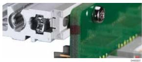
Modulschiene hinten zur Backplanemontage mit Isolierstreifen
