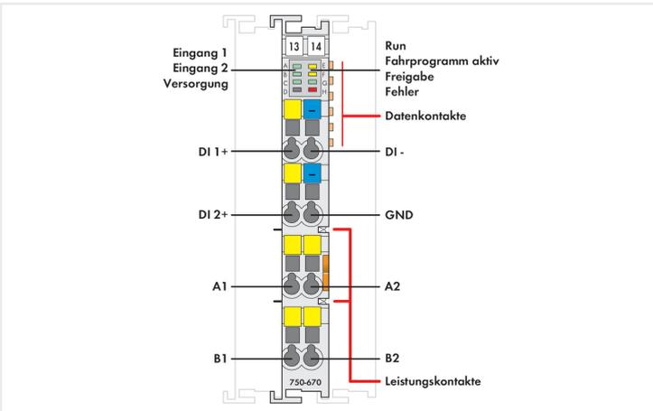
Das Modul 750-670 ist ein intelligenter Steppercontroller zur Ansteuerung von unterschiedlichen Antriebsleistungsteilen mit Puls-Richtungsschnittstelle oder Inkrementalgebereingang.
