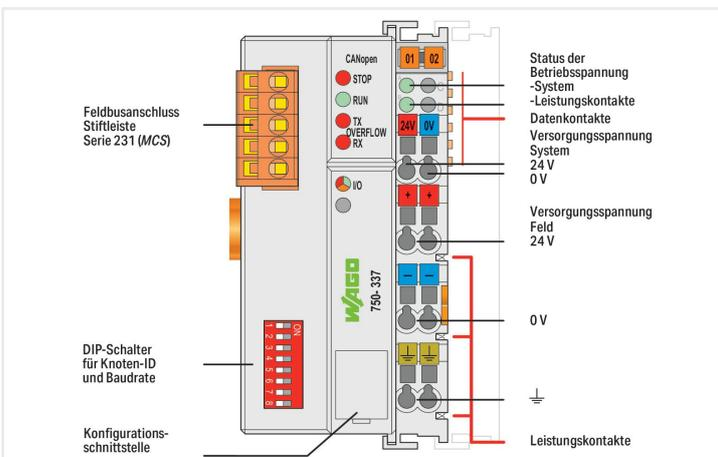
Dieser Feldbuskoppler verbindet das WAGO-I/O-SYSTEM als Slave mit dem CANopen-Feldbus. Die Daten werden mit PDOs und SDOs übertragen.
