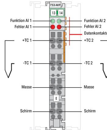
Das Analogeingangsmodul erlaubt den direkten Anschluss von zwei Thermoelementen. Der Betrieb geerdeter Sensoren ist durch die interne galvanische Trennung möglich.
