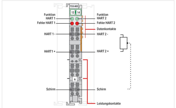
Das Analogeingangsmodule hat die Aufgabe, die im Feld befindlichen Messumformer zu versorgen und analoge Messsignale galvanisch getrennt zum Bussystem zu übertragen.
