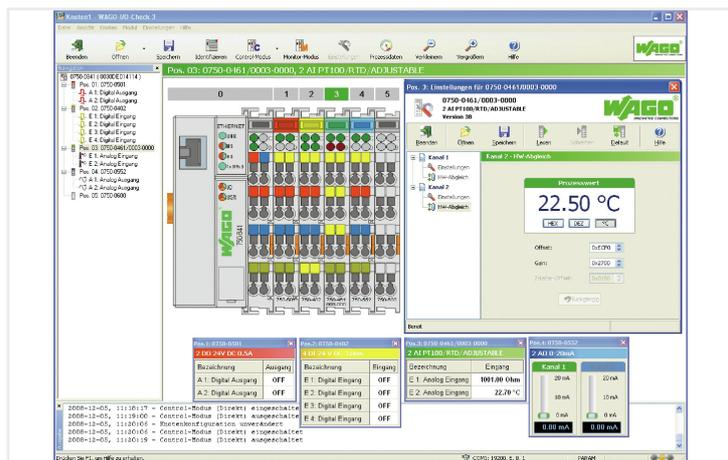
WAGO-I/O-CHECK ist eine einfach zu handhabende Windows-Anwendung zur Bedienung und Darstellung eines Knotens aus dem WAGO-I/O-SYSTEM 750, ohne dass der Knoten dafür an ein Feldbusssystem angeschlossen ist.
