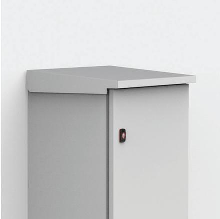
**Beschreibung:** Zur Installation auf Einzelgehäusen im Außenbereich. Das Dach ist leicht geneigt. Gehäusebearbeitung ist nötig. Die Gehäuseabmessungen erhöhen sich um: H=60 mm, T=20 mm und B=20 mm.
