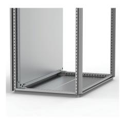
**Beschreibung:** Erzeugt eine Installationsfläche über die gesamte Breite des Gehäuses. Einfach Montage durch seitliche Gleitschienen MTS. Die Nennbreite entspricht der Schrankbreite. Bei angereihten Schränken können die MPW's verbunden werden und es entsteht somit eine durchgängige Installationsebene. Kann nicht in der hintersten Position montiert werden.
