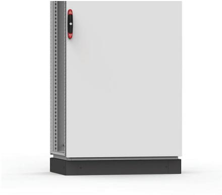
**Beschreibung:** Die Vorder- und Rückblenden erlauben eine uneingeschränkte Verkabelung nach VDE 0113 Standard. Der Sockel besteht aus 4 Ecksegmenten mit abnehmbaren Frontblenden. Die Seitenblenden PS müssen separat bestellt werden. Es gibt alternativ 100 mm und 200 mm hohe Sockel. 200 mm hohe Sockel werden mit 2 abnehmbaren Rückblenden von je 100 mm Höhe geliefert. Die Frontblende besteht aus einem Stück von 200 mm Höhe. Alle Blenden sind zweifach abgekantet.
