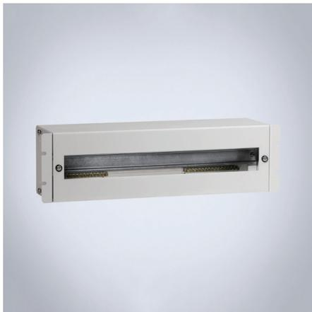
**Beschreibung:** Für Ausschalter-, Schalter- oder Steckdoseninstallation in Gerüsten. Kann bis zu 22 Module (18 mm) aufnehmen. Bis 15 mm tiefenverstellbare DIN-Schiene. Die Box ist mit zwei 10x8 mm Erdungsschienen ausgestattet. Länge: 120 mm mit 15 x M5 Anschlüssen. Kabeleingang auf der Rückseite 400x35 mm. Mit Kabelbürste.
