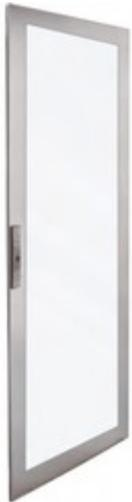
Die Standschränke aus Edelstahl mit Sichttür bestehen aus den folgenden Komponenten: Edelstahl –Sichttür (DGCS), 2 mm starke Edelstahlplatte AISI 304 / AISI 316 (auf Anfrage) aus 240-er vorgeschliffenem Edelstahl (0,5 Mikron im Durchschnitt), Sichtbereich aus 4 mm starkes Sicherheitsglas.
