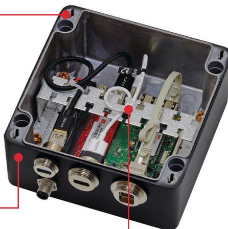
Das oben gezeigte Produkt ist ein EMV-geschütztes Gehäuse mit den Abmaßen H90 x B160 x T160 mm (26880-003) und hat ein integriertes embedded NUC™ Board.
