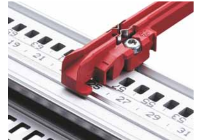
06 Durchlaufende Nummerierungen auf der Modulschiene (> 28 TE) und eine Markierung auf der Führungsschiene geben eine schnelle, optische Positionierhilfe. Vorne und hinten einsetzbare ESD-Clips schützen die Elektronik vor elektrostatischer Entladung
