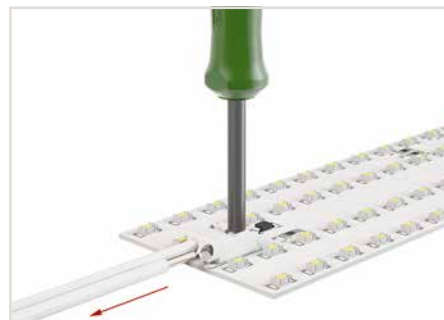
Feindrängige Leiter anschließen und Leiter lösen – durch geringen Druck auf den Betätigungsdrücker, z. B. mit Betätigungswerkzeug 206-861.
