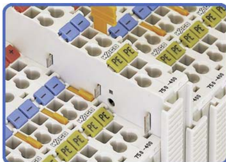
Sichere, automatische Verbindung durch verzinnte, selbstreinigende Gleitkontakte mit hoher Kontaktsicherheit – Schutzkontakt voreilend (Serie 750 und 753)
