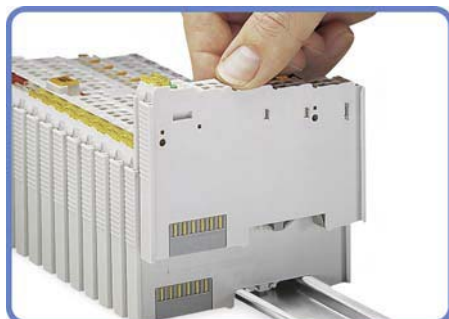
Feingranularer Aufbau auf der Tragschiene . . .
