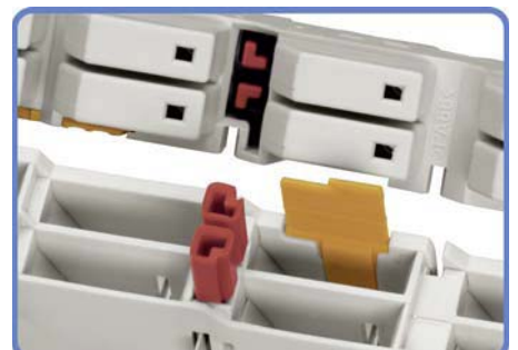
Der so kodierte Stecker kann nur noch in das entsprechende Unterteil gesteckt werden.
