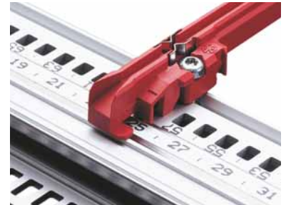
Durchlaufende Nummerierungen auf der Modulschiene (> 28 TE) und eine Markierung auf der Führungsschiene geben eine schnelle, optische Positionierhilfe. Vorne und hinten einsetzbare ESD-Clips schützen die Elektronik vor elektrostatischer Entladung
