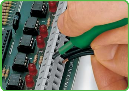
Leiter anschließen – mit Schraubendreher 3,5 mm. Betätigung und Leitereinführung aus gleicher Richtung.
