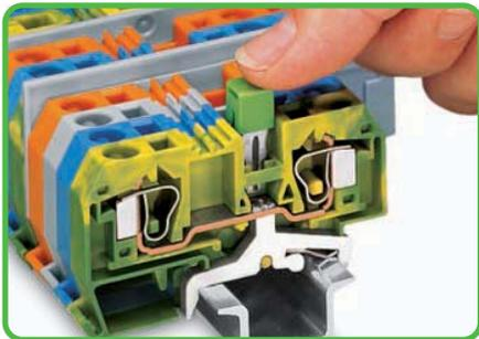
Schutzleiterklemmen lassen sich mit Querbrücken in einer Richtung (über die Klemmenrückwand) mit Durchgangsklemmen brücken. Zusätzlich zur Kennzeichnung dieser Klemmen empfehlen wir die Verwendung der gelbgrünen Querbrücken.
