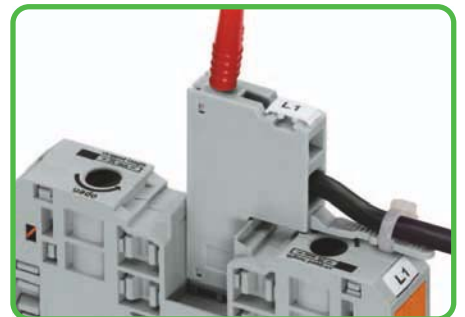
Der Potentialabgriff wird im Brückerschlitz montiert. Er kann mit einer Zugentlastungsplatte versehen werden und bietet eine Prüfmöglichkeit für Prüfstecker Ø 2 mm.
