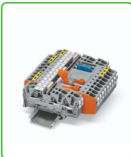
Klemmenblock bestehend aus: Durchgangsklemmen Trennklemmen Sicherungsklemmen für KFZ-Sicherungen
