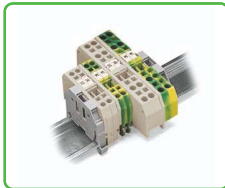
Abschluss- und Zwischenplatte Zur Einhaltung der im Bereich Ex e geforderten Kriech- und Luftstrecken muss zwischen einer Durchgangs- und einer Schutzleiterklemme grundsätzlich eine Abschluss- oder Zwischenplatte gesetzt werden.
