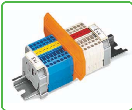
Trennwand Ex e/Ex i Nach EN 50020 ist zwischen Anschlussstellen von Stromkreisen Ex e und Ex i ein Mindestabstand von 50 mm einzuhalten. Bei der Montage von Reihenklemmen Ex e und Ex i auf einer gemeinsamen Tragschiene kann das platzsparend durch Nutzung der Trennwände Ex e/Ex i gelöst werden. Passend für Serien 279 bis 282: 209-190 für 2-Leiter-Klemmen 209-191 für 2-, 3-, 4-Leiter-Klemmen
