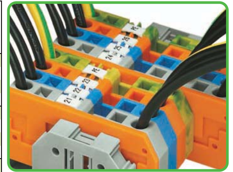
Bei Klemmenkennzeichnung durch Mittenbeschriftung wird die Beschriftungsebene nicht durch angeschlossene Leiter verdeckt.
