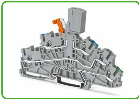
Installationsetagenklemme (2003-6641) mit eingesetztem N/L-Prüfadapter (2003-499) zur Isolationswiderstandsmessung mit verbundenen N- und L-Potentialen
