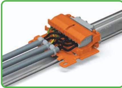
Liegende Montage mit Zugentlastungsplatte auf Tragschiene DIN 35 mittels Universalwinkeladapter
