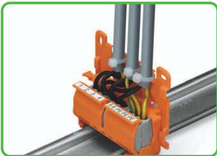
Senkrechte Montage mit Zugentlastungsplatte auf Tragschiene DIN 35. Klemmstellenkennzeichnung durch Beschriftungsstreifen
