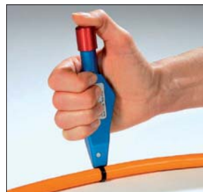
3. Per Daumendruck den Schneidevorgang auslösen.
