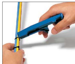
Abschneiden durch Drehen des Werkzeuges.
